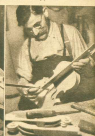
Poszczególne fazy budowy skrzypiec (od lewej): Wycinanie otworów rezonansowych w kształcie litery f. — Przytwierdzanie boków, które połączą górną i dolną płytę skrzypiec. — Wprawianie szyjki. — Sprawdzanie menzury skrzypiec. (Zdjęcia z „francuskiej Cremony” — Mirecourt).
