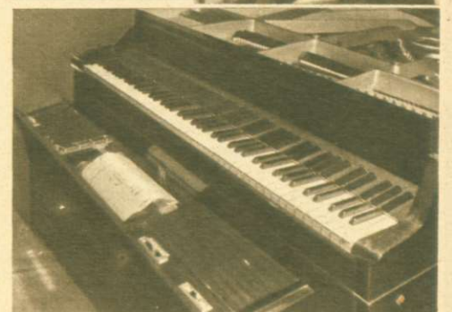
Oto jak wygląda „Ampico“ z wyciągniętą szufladą, gdzie zakłada się rolkę nutową. Fot. „As“
