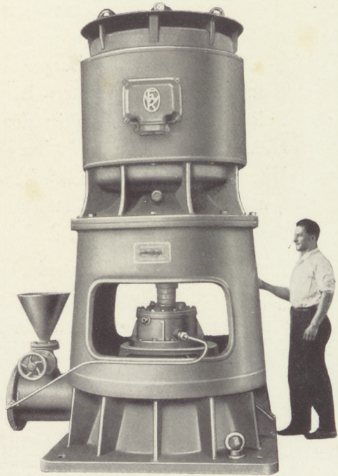
Vertikal-Motor 250 PS für Pumpenantrieb
